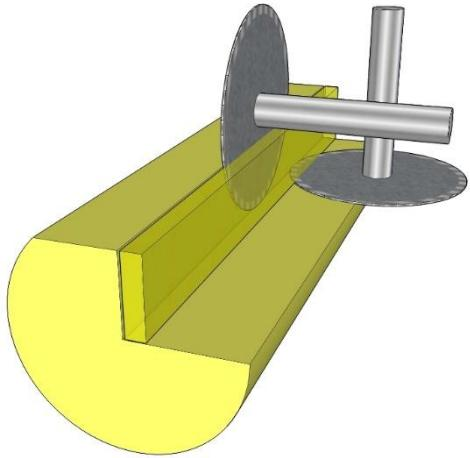
Распиловка производится двумя пилами, установленными под углом 90° и сдвинутыми друг относительно друга в горизонтальной плоскости. Оператор с выносного пульта управляет автоматизированным перемещением пильной каретки в трех направлениях.
