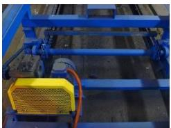
**Транспортер для удаления опилок из-под станка.** Позволяет нажатием одной кнопки вынести накопившиеся опилки из-под станины станка в переднюю, или заднюю часть станины, туда, откуда ее удаление будет более удобным. Таким образом, существенно экономится время и повышается производительность (6,5м – 215 000 руб., 8,5м – 230 000 руб., 9,5м – 237 500 руб., 10,5м – 245 000 руб., 12м – 260 000 руб.).
