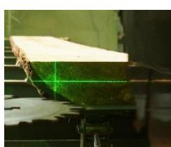
**Лазерные указатели пропилов.** Лазер проецирует линию пропила на бревно, позволяя оператору точно контролировать перемещение пильного узла и правильное положение бревна. Можно поставить 1 (на вертикальный пропил) или 2 лазера (на оба пропила), «тип 1» (видимая длина луча 2-3м) – 3000 руб./шт., «тип 2» (видимая длина луча 4-5м) – 7 500 руб./шт., «тип 3» (видимая длина луча 6-8м) – 18 000 руб./шт.).
