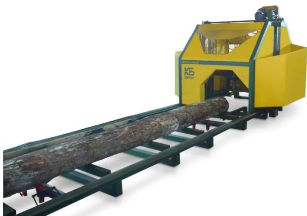
Дисковая угловая пилорама "ВЯТКА 600" - современный инструмент для получения, обрезной доски и бруса, без кантования бревна. Пилорама сочетает в своей конструкции универсальность, гибкость, простоту использования, высокое качество готовой продукции, высокую надежность всех узлов.
