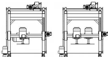
**Поворотный узел для горизонтального пиления:** Оснащение станка одним поворотным пильным узлом позволяет переводить пилораму из углового режима пиления в горизонтальный. Таким образом, в зависимости от текущих потребностей и имеющегося сырья можно использовать станок и как угловую пилораму и как пилораму горизонтального пиления. В стоимость входит две пары зажимов для фиксации лафета в вертикальном положении. (+ 56 000 руб.)
