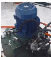
**Гидростанция:** необходима для функционирования гидравлического оборудования, такого как "Гидравлический зажим бревна", "Кантователь бревен" и "Боковой загрузчик бревен" (+ 175 000 руб.).
