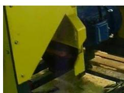
**Сбрасыватель доски на обратном ходу.** Простое и надежное устройство, обратным ходом каретки выталкивает отпиленную доску с бревна. Минимизирует время уборки отпиленной доски (нет простоя каретки) и позволяет работать на станке даже в одиночку (+ 12 000 руб.).
