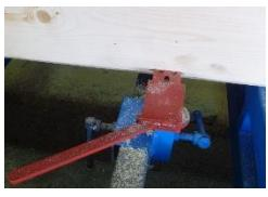
**Боковые винтовые зажимы бревна вместо эксцентриковых.** Позволяют практически не уделять внимания правильному положению бревна на раме станка. Винтовые зажимы сами фиксируют бревно в нужном (центральном) положении. Однако они более капризны, винты требуют постоянного ухода, смазки, очистки от опилок.
