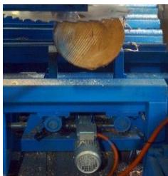
**Электромеханический или гидравлический зажим бревна.** Позволяют существенно ускорить и облегчить процесс фиксации бревна на станине станка. Гидравлический зажим обладает повышенной надежностью (электромеханический: + 170 000 руб., гидравлический: + 165 000 руб.).
