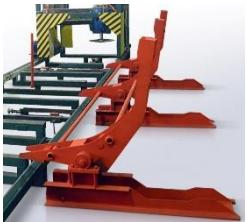
**Боковой загрузчик бревен:** позволяет быстро и без усилий загрузить бревно на станину станка, оснащается гидравлическим приводом (для бревен до 6,5м: + 275 000 руб., до 8,5м: + 360 000 руб., до 10,5м: + 440 000 руб.).
