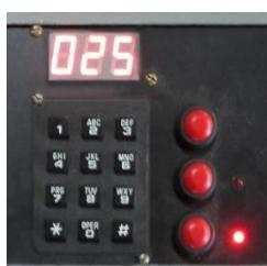
**Оснащение каретки системой электронных линеек.** Позволяет значительно быстрее и точнее передвигать пильный узел. Оператор на пульте выбирает требуемое значение перемещения пилы, нажимает кнопку, пильный узел в автоматическом режиме перемещается на заданное расстояние (в «базе»).
