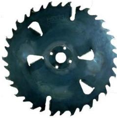
Прорези для выноса опилок и выкидные зубья, которыми оснащены данные пилы, способствуют более стабильному, чистому и скоростному пилению. Зачистные ножи предохраняют тело пилы от контакта с древесиной, предотвращая таким образом, перегрев пильного диска.
