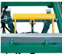
**Подъем вершины бревна.** Поднимающаяся дополнительная опора (может подниматься вручную или с помощью гидравлики) позволяет, в случае необходимости, выровнять положение бревна, например, в случае сильно выраженной конусности или комлистиности. Доски, выпиленные параллельно оси роста бревна, считаются более качественными (механический: + 8 000 руб.). Гидравлический вариант (+ 50 000 руб.) ставится только в комплекте с "Гидравлическими зажимами бревна", "Кантователем бревен" или
